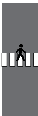
Bandes blanches pour passage des piétons
