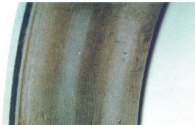
Figure 6 Ajustement trop serré ayant causé de l'usure prématurée à la portée intérieure du roulement
