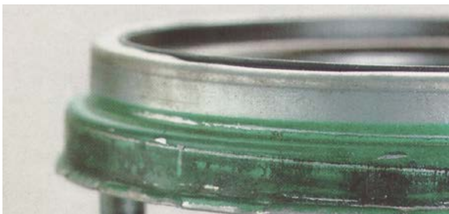
Figure 8 Déformation de la gaine métallique causée par l’utilisation d’outils inadéquats
