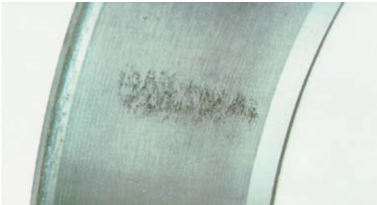
Figure 2 Présence de particules métalliques ou abrasives dans le lubrifiant
