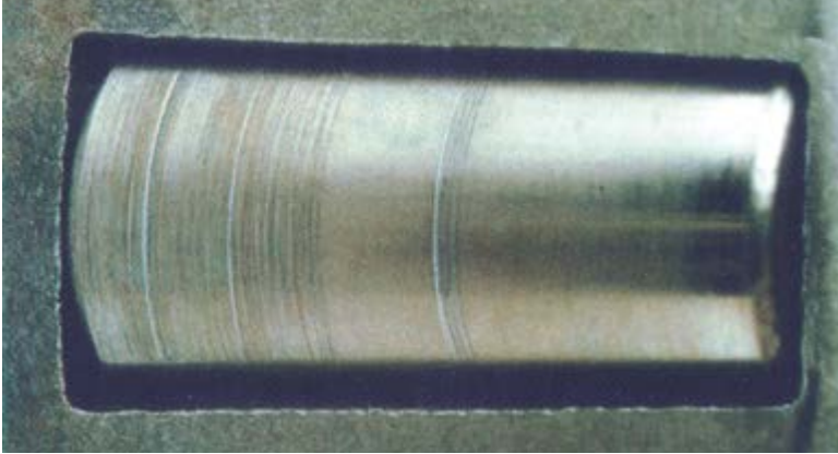
Figure 3 Présence de particules métalliques ou abrasives dans le lubrifiant
