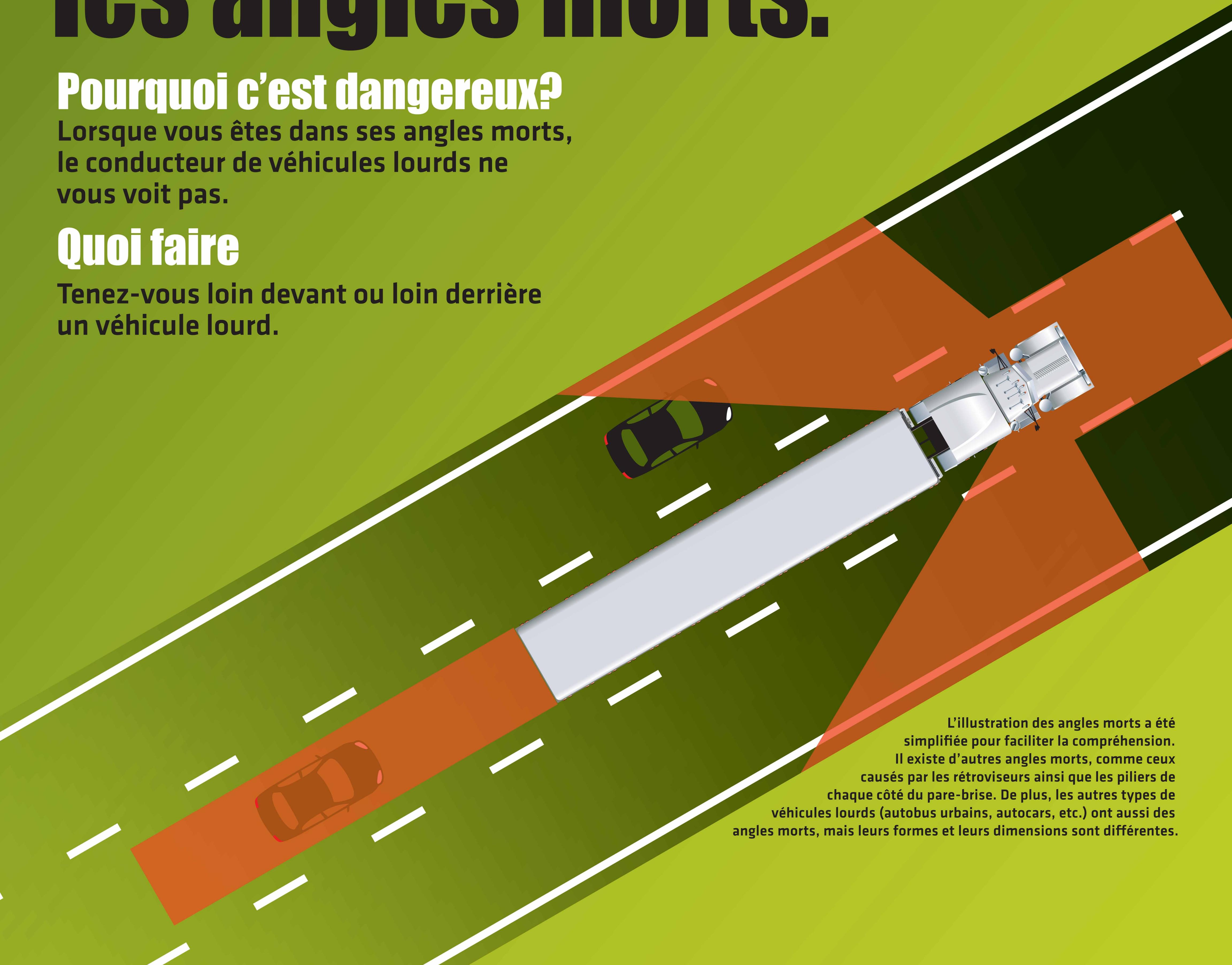
L'illustration des angles morts a été simplifiée pour faciliter la compréhension. Il existe d'autres angles morts, comme ceux causés par les rétroviseurs ainsi que les piliers de chaque côté du pare-brise. De plus, les autres types de véhicules lourds (autobus urbains, autocars, etc.) ont aussi des angles morts, mais leurs formes et leurs dimensions sont différentes.
