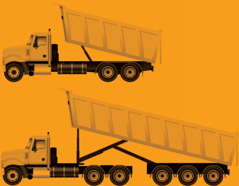
À partir du **1er septembre 2020**, tous les véhicules lourds ou ensembles de véhicules lourds dont **la benne basculante excède 4,15 m de hauteur en position relevée** devront être munis d'un avertisseur sonore et d'un témoin lumineux qui s'activent automatiquement lorsque la benne n'est pas complètement abaissée. Tous les accessoires, même temporaires, comme les contreplaqués utilisés pour le déneigement, devront être pris en compte dans la mesure de la hauteur.
