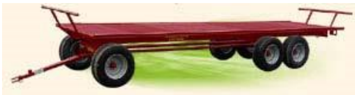
Illustration 3 Remorque de ferme avec timon et essieu directionnel sur pivot
